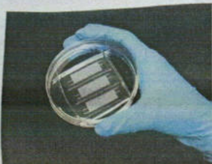
In mikrofluidischen Strukturen können Tausende einzelner Zellen eingedampft und über sehr lange Zeiträume kultiviert und analysiert werden.
